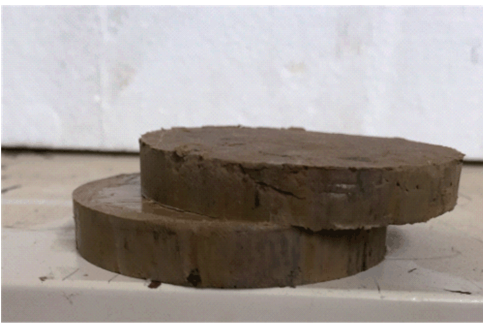
图 2 反复四次剪切的土样
